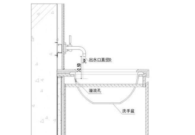
图 7.8.1 洗手盆出水口设置示意图
