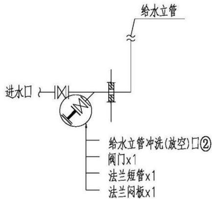
图 5.1.2 给水立管冲洗（放空）口设置示意图
