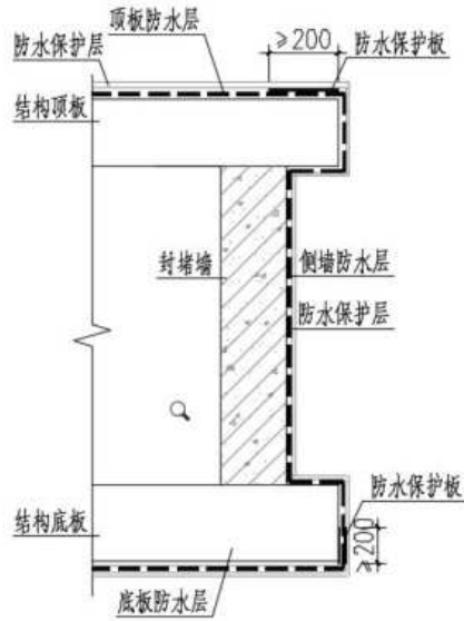
图 9.2.1-5 管廊接口处防水做法
