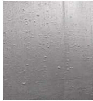
图 6.2.1-2、3 涂层成膜膜面不合格
