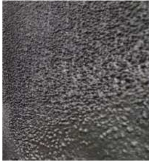
图 6.2.1-2、3 涂层成膜膜面不合格
